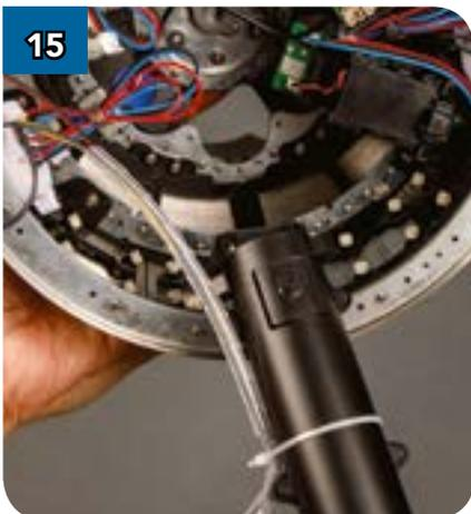
15 Поднесите механизм извлечения к куполу так, как показано на фотографии (чтобы его провода и двигатель находились слева).
