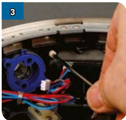
3 Закрутите винт в первое из отверстий...
