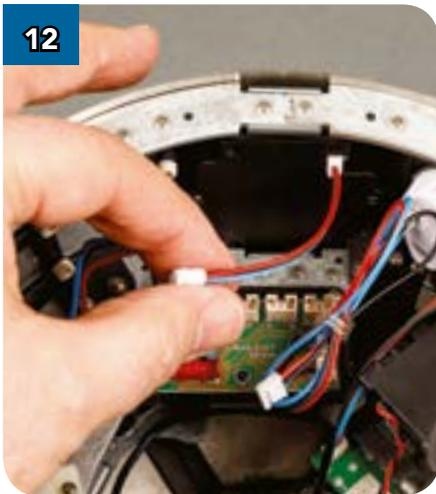
12 Теперь возьмите короткие провода жидкокристаллического дисплея, расположенного возле платы.
