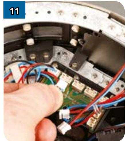
Вставьте вилку этих проводов во второй разъём, имеющий маркировку LCD1.
