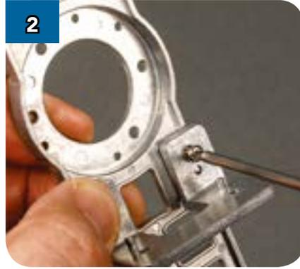
2 Закрутите винт 2,5 x 6 мм в крепёжное отверстие детали (BF-11), чтобы закрепить конструкцию.
