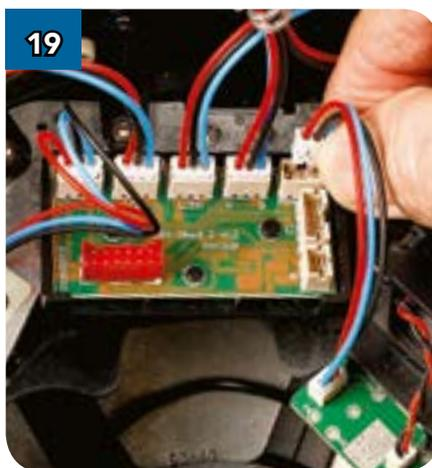
19 ...и вставьте их вилку в крайний разъём, обозначенный словом Projector.
