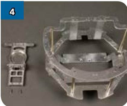
4 Возьмите собранную конструкцию, готовую часть каркаса и два винта 2,5 x 8 мм.
