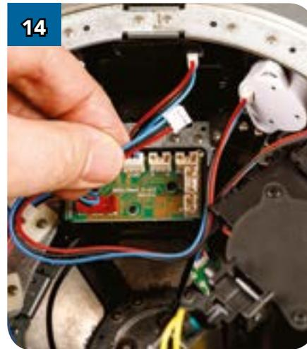
14 Расправьте провода второго индикатора состояния процессора.
