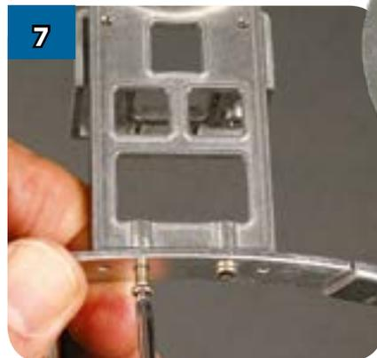
7 Закрепите деталь (BF-10) на каркасе с помощью двух винтов 2,5 x 8 мм.
