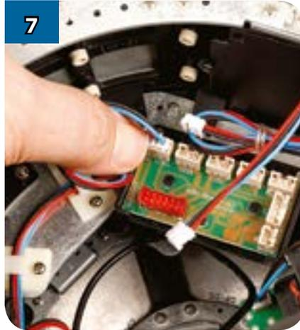
...и вставьте вилку проводов в крайний разъём, помеченный буквами G и Y.
