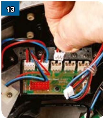
13 Вставьте их вилку в третий разъём, обозначенный как LCD2.
