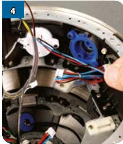
Расправьте провода индикатора состояния процессора, изображённого на фотографии.
