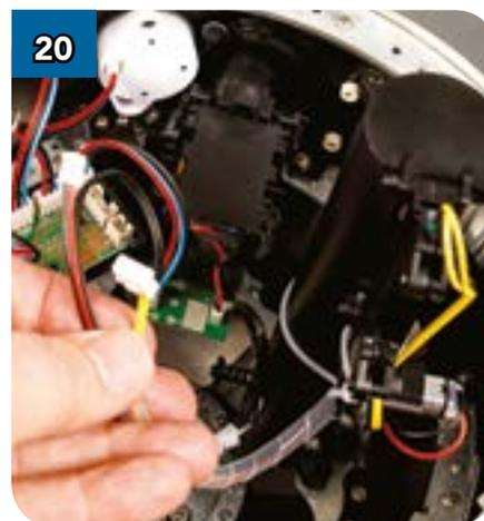
20 Возьмите провода механизма извлечения светового меча, на концах которых имеются две вилки.
